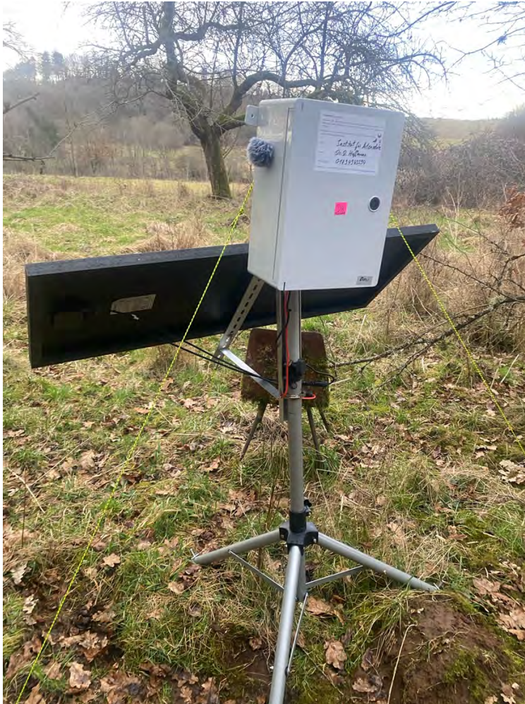
Abbildung 3: KI-gestützte Horchbox der Firma TrackIT-Systems mit Solarpanel zum dauerhaften autarken Betrieb (Foto: D. Hoffmann, Anlage TrackIT-Systems)
