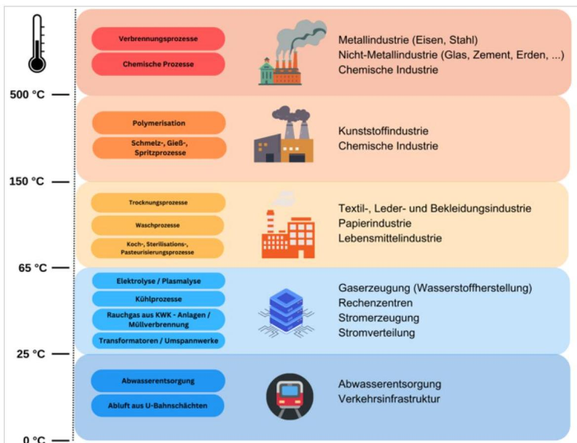
Abbildung 21: Temperaturniveau der Abwärme nach Industriezweigen Quelle: (Dunkelberg, 2023)
